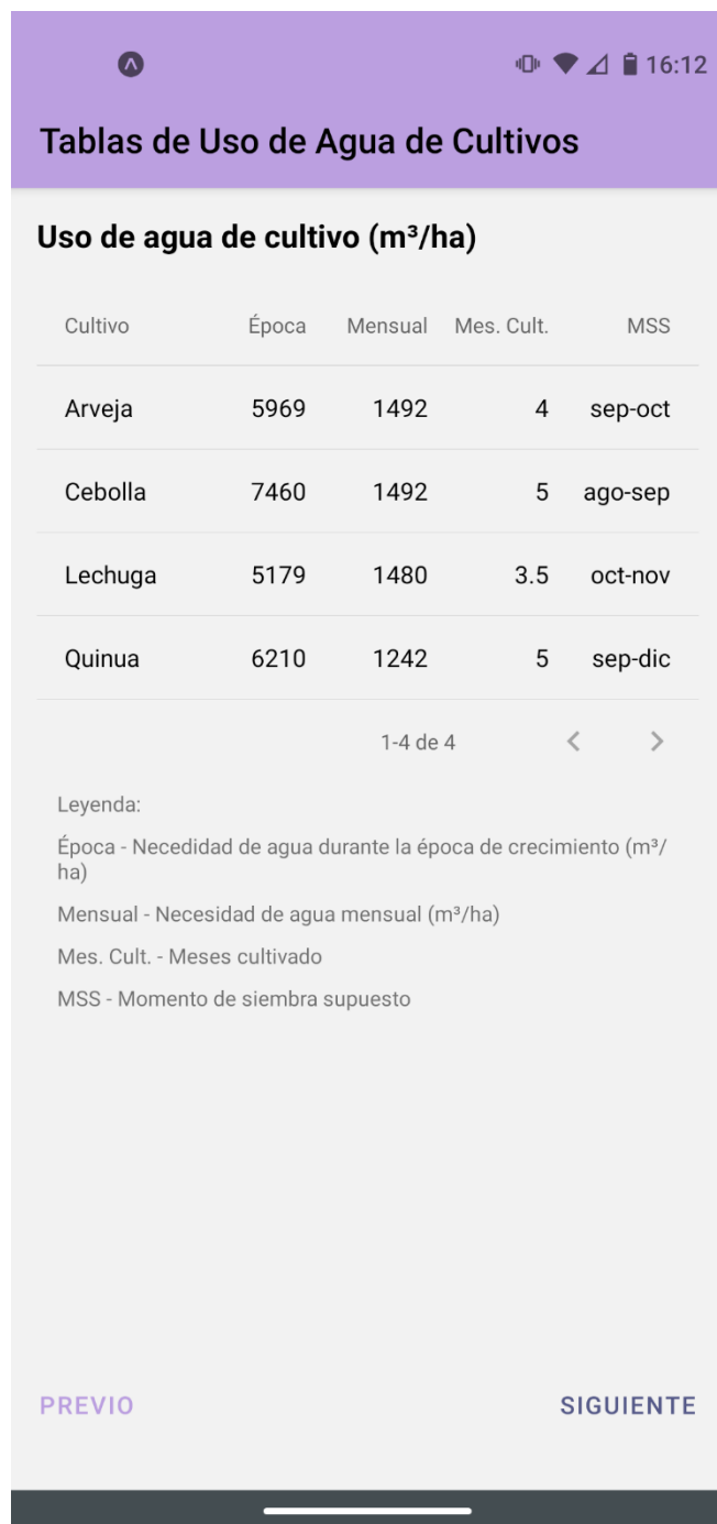
Figura 7. La pantalla de resultados muestra el volumen de agua que necesita cada cultivo.
